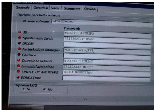
Tutti gli ecografi prodotti dal 1998 in poi hanno un computer con Sistema Operativo Windows (NT4, Windows 2000, Xp) e Linux . Questo puo' bloccarsi e l' ecografo si blocca di conseguenza. Le funzioni dell' ecografo sono sottoposte ad abilitazione con password ( vedi a lato ).
